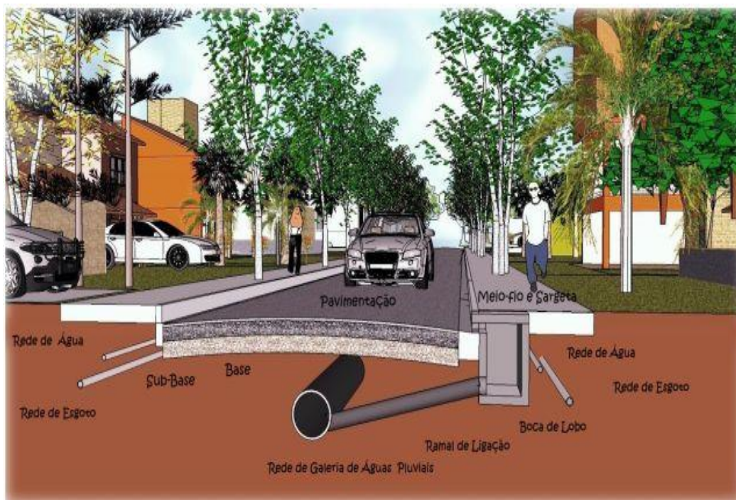
Figura 1 – Exemplo de sistema de microdrenagem urbana.
