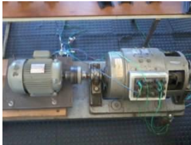
Figura 7: Grupo motor gerador a ser utilizado
