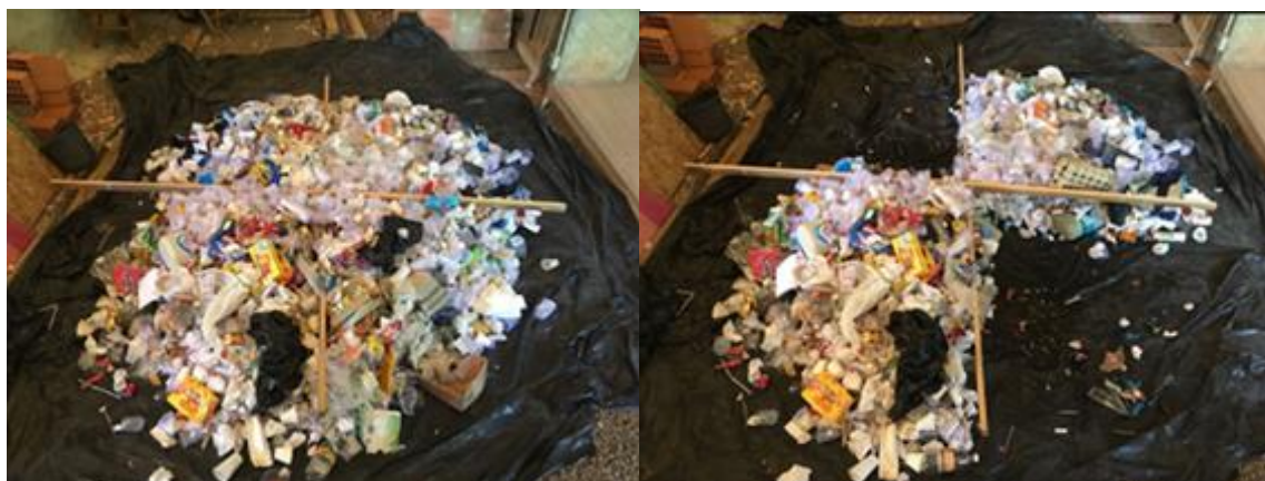
Figura 3: (a) Resíduo potencialmente reciclável de um dia; (b) Quarteamento. Fonte: Autores, 2019
