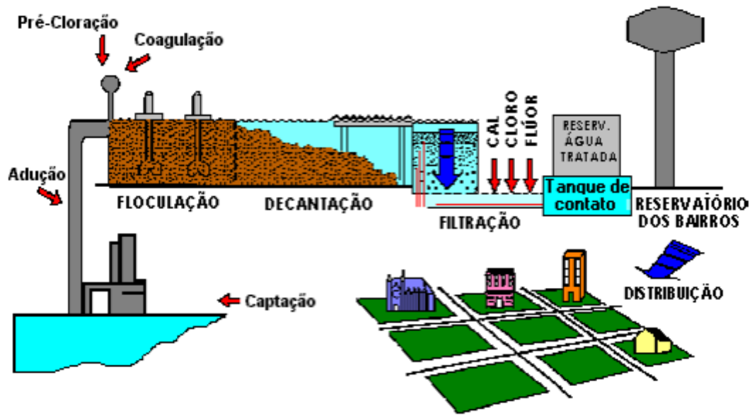
Figura 1 - Etapas do processo de tratamento de água convencional em ETA
