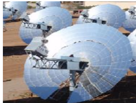
Figura 9 – Solar concentrator parabolic disk Fonte: Eco harmonia (2018)
